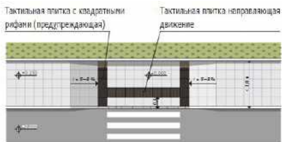
Схема 4. Наземный пешеходный переход, расположенный перпендикулярно движению пешехода на ограниченной территории. Ширина пешеходного тротуара — менее 3,0 м. Размещение тактильных указателей
