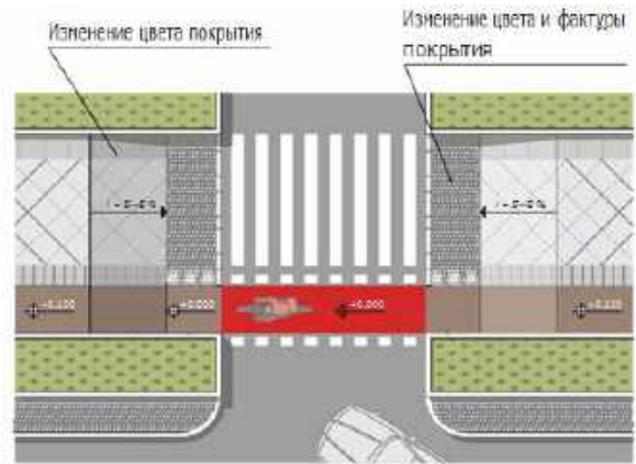
Схема 2–1. Пример организации предупреждающих покрытий при помощи изменения цвета, фактуры и типа укладки
