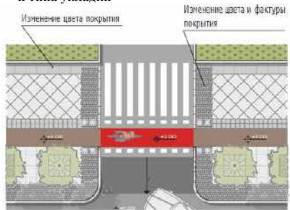
Схема 2–1. Пример организации предупреждающих покрытий при помощи изменения цвета, фактуры и типа укладки
